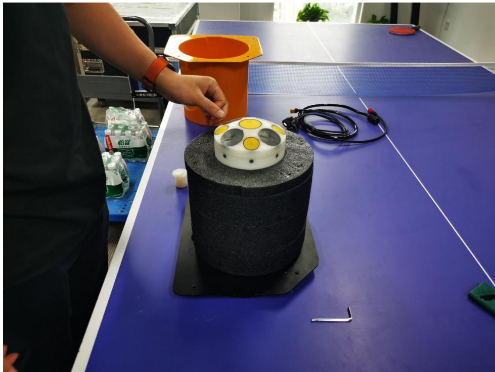
(3) 取下穿线孔防水胶塞，将 ADCP 的数据线缆穿过穿线孔；
