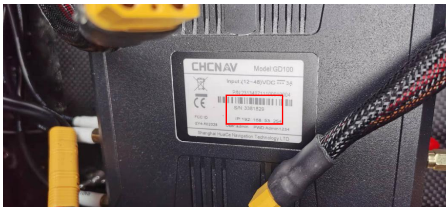
图 3-2 输入船的 SN 号（主控盒子上部）
