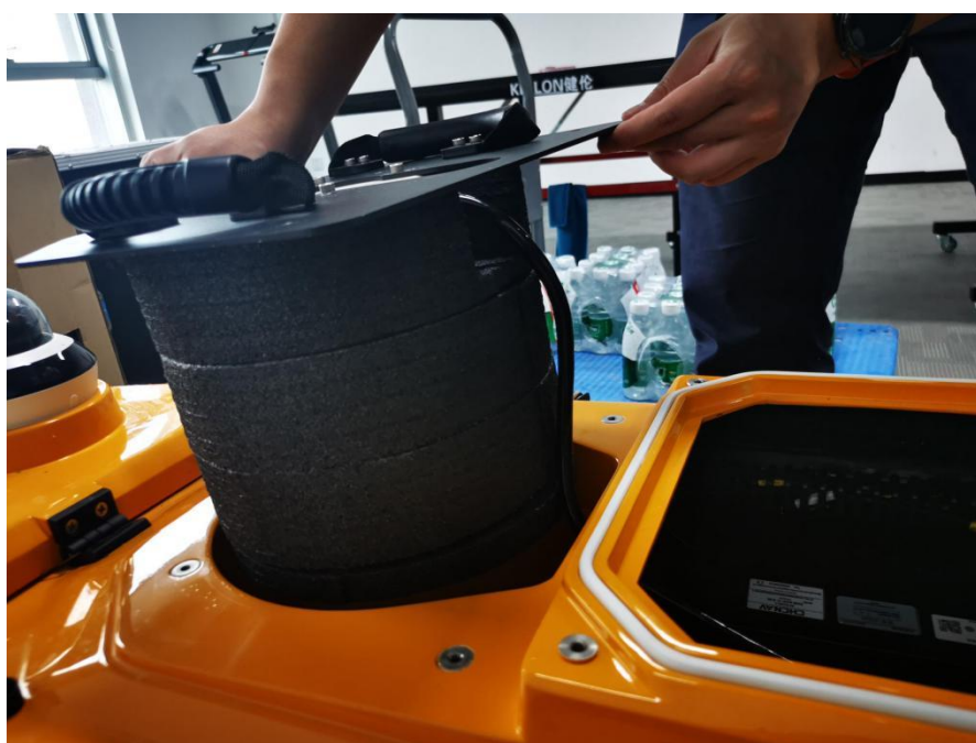
(6) 连接好 ADCP 串口线和供电线；
