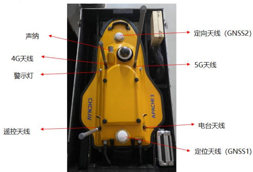
图 2-2 船体表面配件安装
