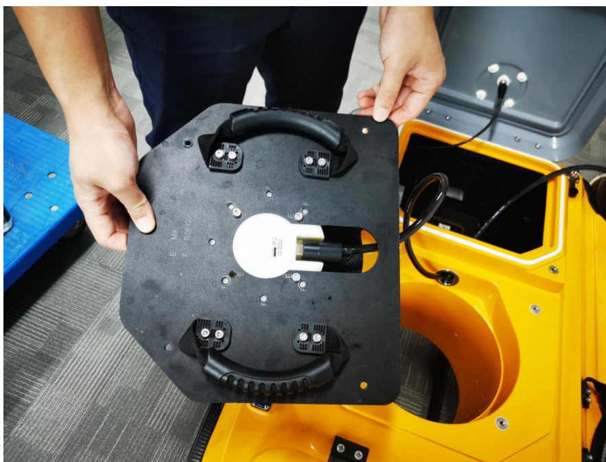
(5) 安装好碳板，塞紧穿线孔的防水胶塞；
