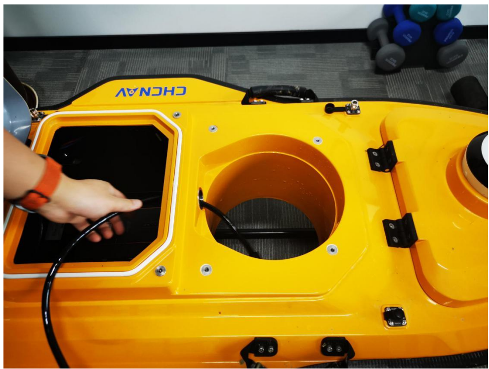
(4) 线缆插头插入 ADCP 并用螺帽拧紧固定；
